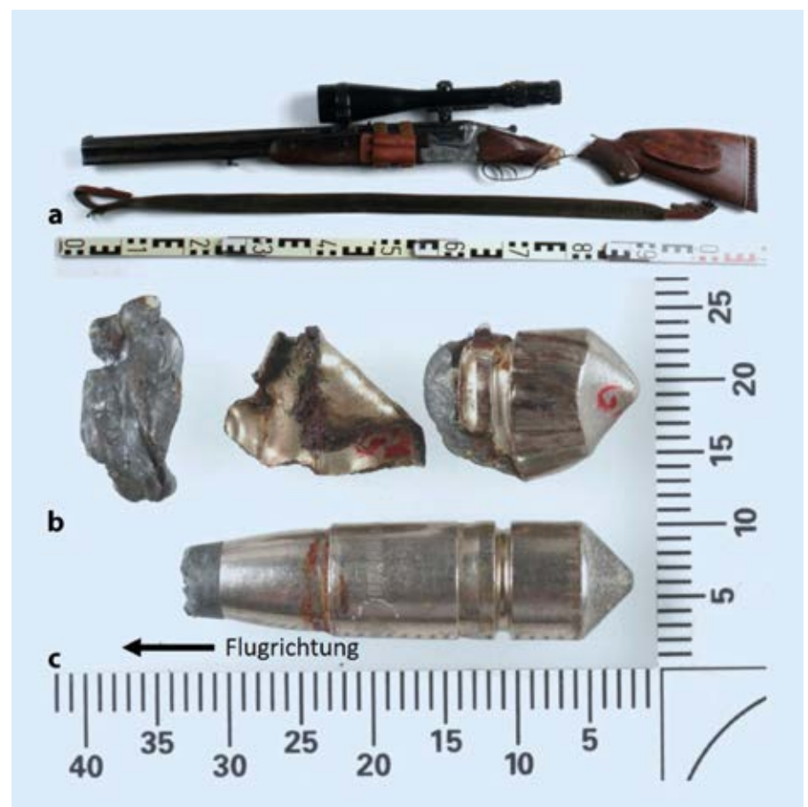
Abb. 3: Bockbüchsfinte mit zerbrochenem Schaft. b Bei der Sektion geborgene Projektilfragmente aus dem Schusskanal (Abb. 4) zwischen den Punkten 3 und 4. c Delaboriertes Projektil RWS 8 × 57 JRS, Torpedo-Ideal-Geschosse
